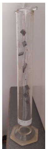
Přípravené vzorky před nalitím pórového roztoku betonu
